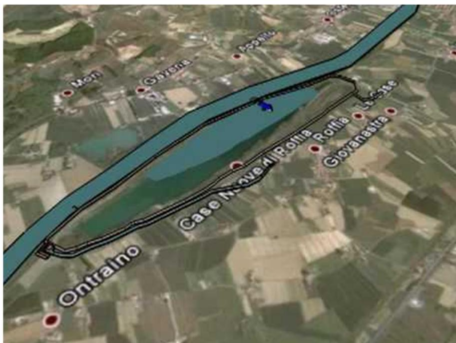
Il bacino di espansione è permeabile. Consente il mantenimento di una zona umida anche dopo il ritiro delle acque del fiume. Riduce l'onda di piena.
